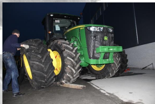
Рис. 6 Подкладка доски под колеса
