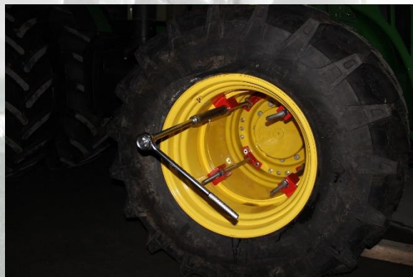
Рис. 7 Расположение замков и стяжек
