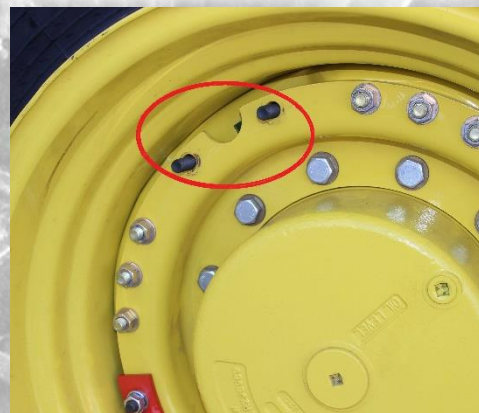
Рис. 2 Болт М16х90 с гайкой и гровером.
